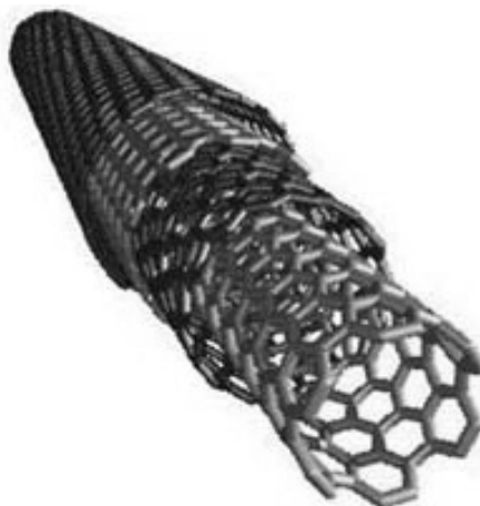
Рис. 2 Многослойные углеродные нанотрубки [4]
